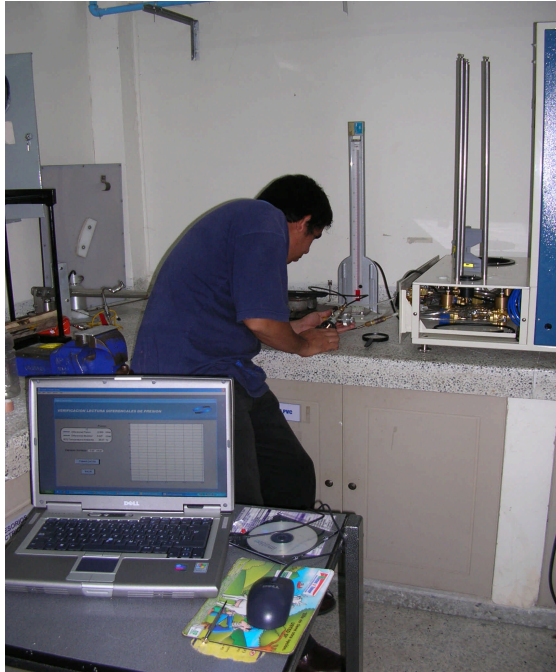
Figura 51. Calibración diferenciales del presión del patrón primario tipo pistón
