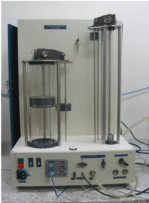
Figura 66. Patrón primário tipo pistón vista frontal (Izq) Sistema de control (Der)
