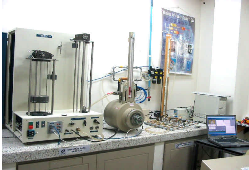
Figura 64. Calibración de Cámara Húmeda Utilizando Encoder con el Pistón Grande Operando en Ascenso
