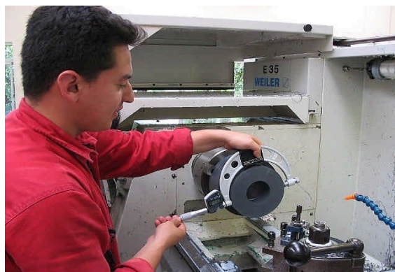
Figura 23. Medición del Diámetro del Pistón Durante el Proceso de Fabricación
