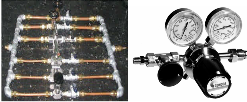
Figura 30. Manifold de Regulación de Caudal y Regulación de Alta Presión para el Fluido de Calibración.
