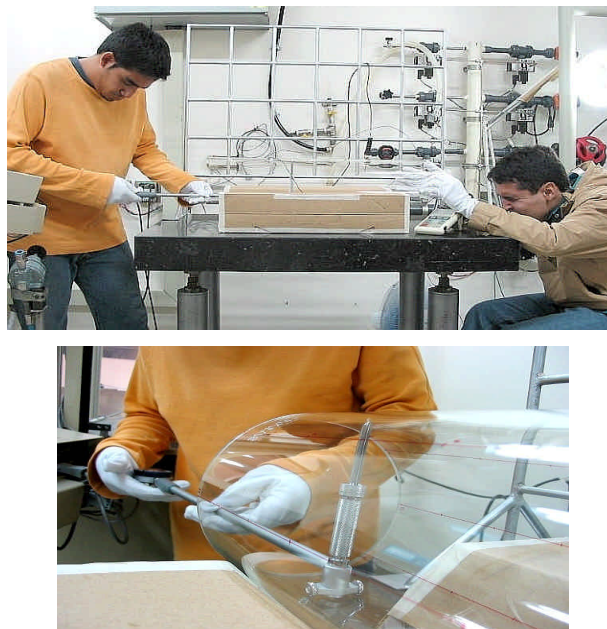
Figura 43. Calibración del Patrón Tipo Pistón por el Método Dimensional
