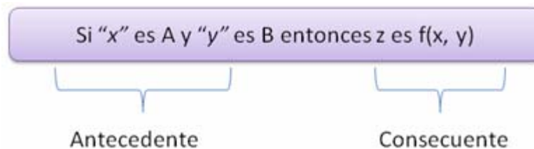
Figura 17. Partes de una regla difusa de tipo Sugeno.
