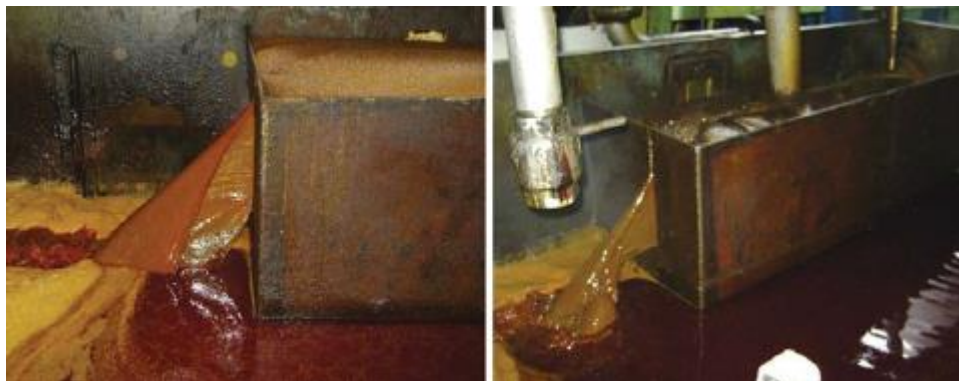
Figura 1 – Anexo I. Vertedero rectangular para medición de flujos volumétricos
