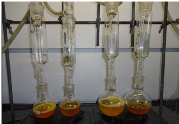
Figura 1- Anexo D. Montaje de las muestras para extracción mediante Soxhlet.
