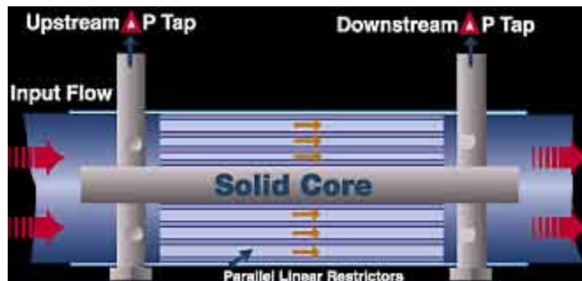
Figura 12. Diseño tipo matriz con tomas de presión diferencial tipo Pitot
