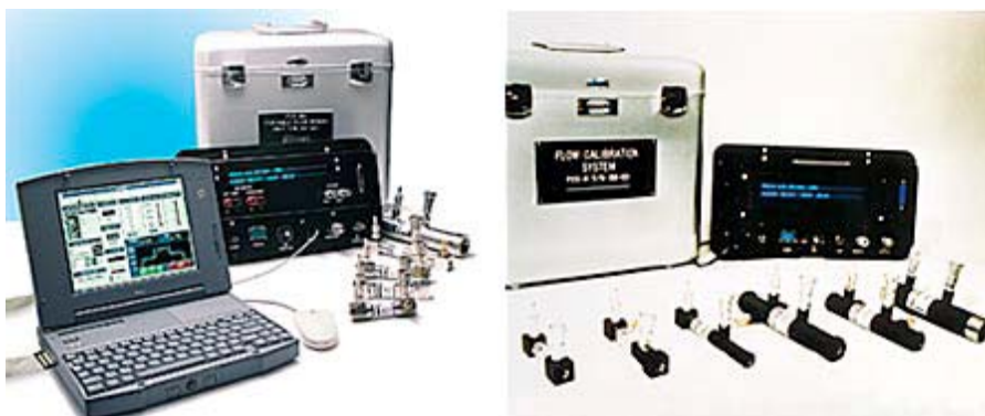
Figura 10. LFEs con sistema electrónico de adquisición y procesamiento de datos
