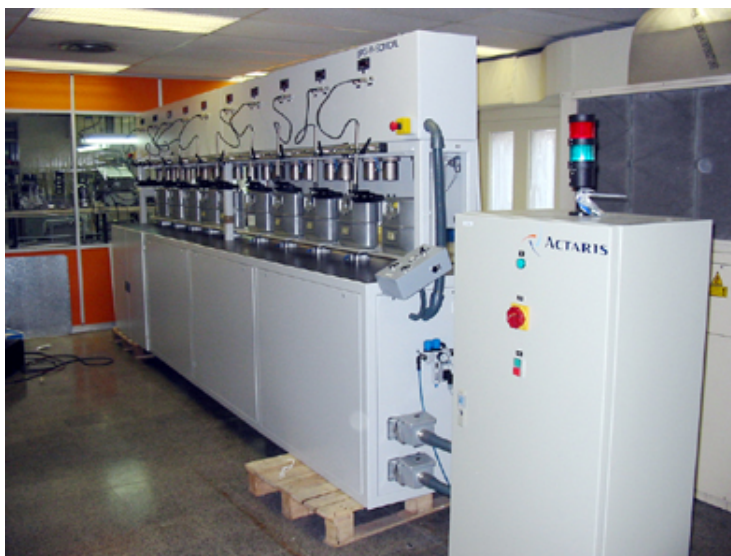
Figura 23. Banco de calibración de medidores residenciales con toberas de flujo crítico
