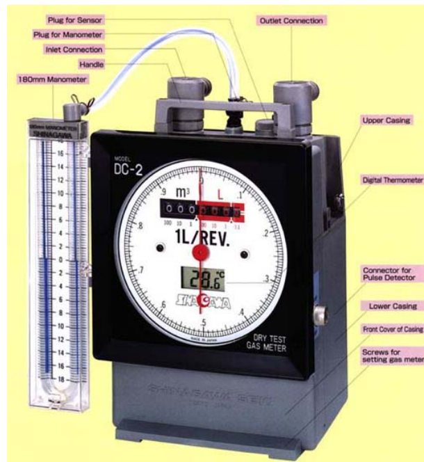
Figura 18. Actualización tecnológica del patrón tipo medidor seco
