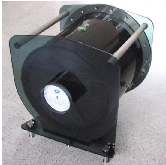
Figura 19. Patrón secundario tipo cámara húmeda
