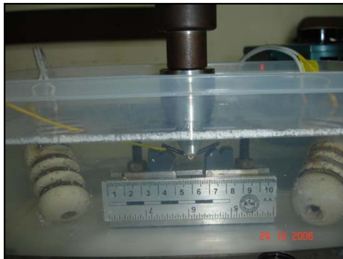
FIGURA 3.19 Montaje de la celda en la máquina de ensayos universales Shimadzu para realizar los ensayos de flexión a 37 y 100°C.
