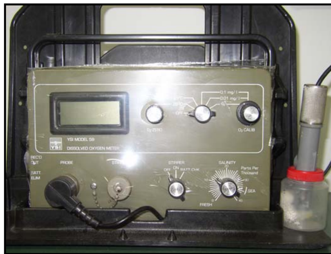
FIGURA 3.10. Equipo utilizado para medir la concentración de oxígeno disuelto en la solución fisiológica, marca YSI modelo 58.
