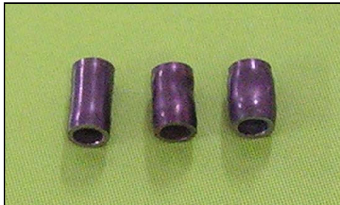
FIGURA 4.12 Morfología de las probetas ensayadas en compresión
