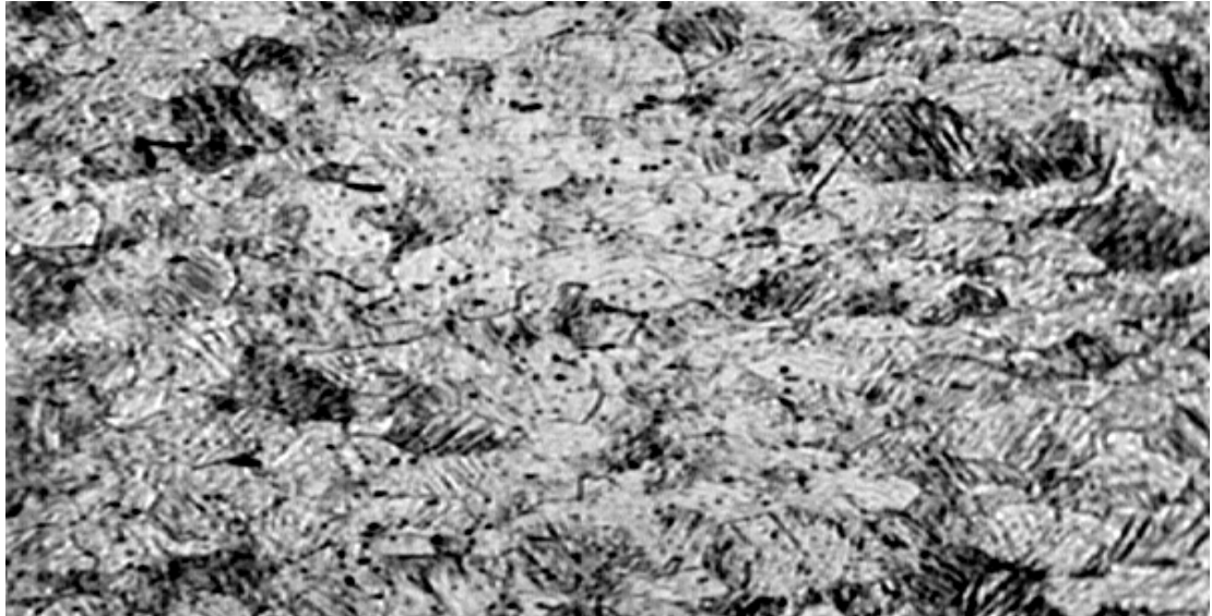
FIGURA 4.2 Microestructura de microtubos Ni-Ti sección longitudinal 100 aumentos por microscopía óptica.
