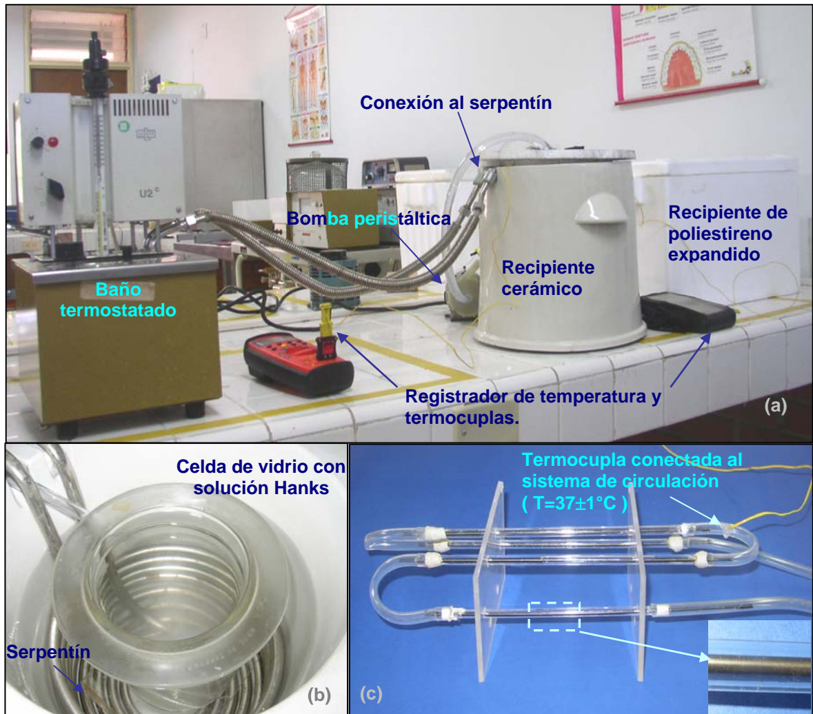
FIGURA 3.9. Montaje de un sistema de circulación de solución fisiológica para la exposición de microtubos de Ni-Ti: (a); interior del recipiente cerámico que contiene una celda de vidrio para almacenar la solución fisiológica y un serpentín para su calentamiento (b), y disposición de las muestras de nitinol en los tubos de cuarzo los cuales son aislados en un recipiente de poliestireno expandido (c). Fuente: Las autoras.
