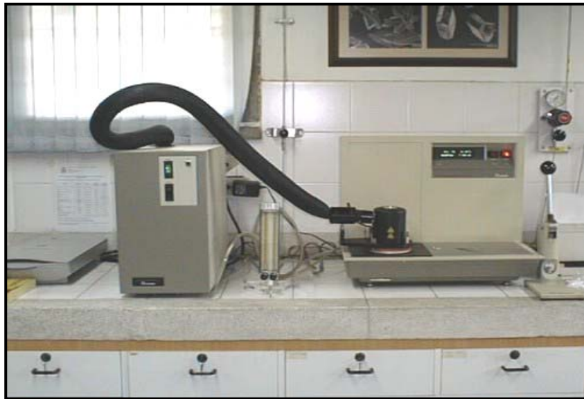
FIGURA 3.5. Calorímetro TA Instruments, DSC 2920 utilizado para determinar las temperaturas de transformación de la aleación Ni-Ti.
