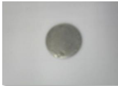
Fotografía 6. Probeta de titanio recubierta con PLGA.
