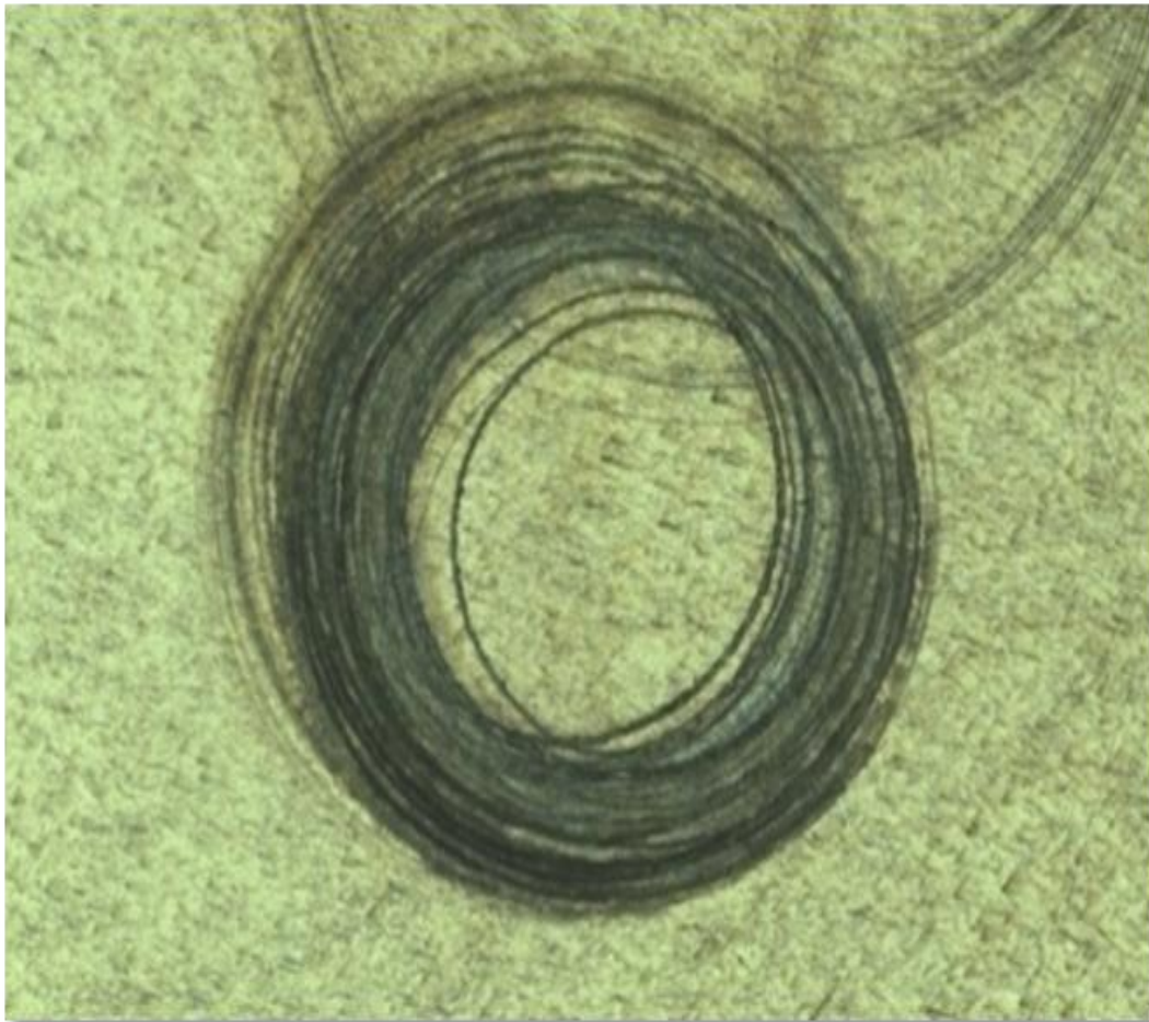
Fotografía 8. Morfología de la superficie de rayado del titanio puro.
