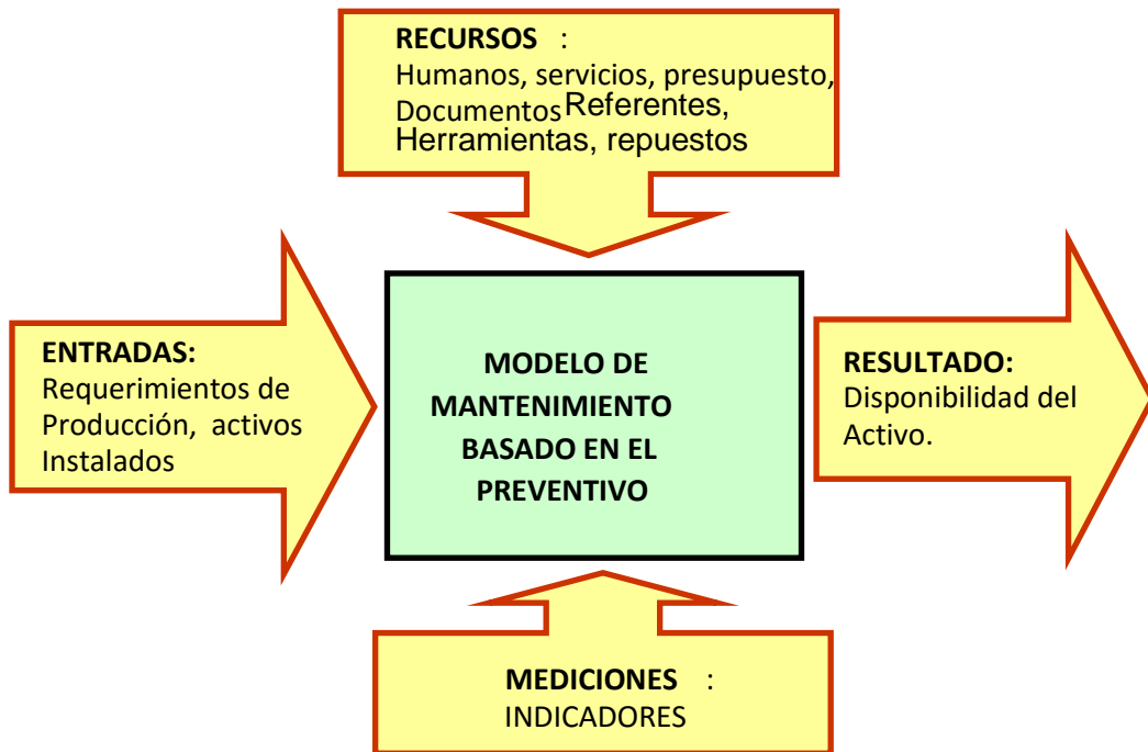
Figura 6. Entradas y salida del PROGRAMA GERENCIAL DE MANTENIMIENTO.
