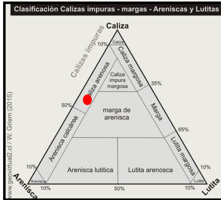
Figura 32. Diagrama triangular para la clasificación de rocas intermedias según Correns(1949), el círculo rojo representa la clasificación que obtuvo la muestra.
