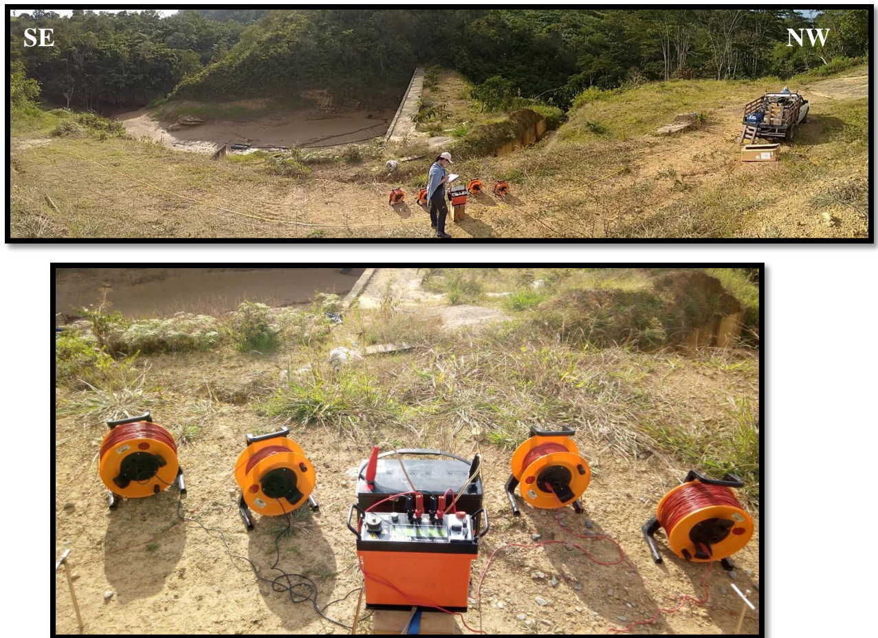
Figura 52. Ubicación del equipo utilizado para el análisis de geoelectrica.
