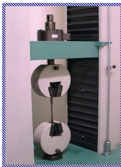
Foto 3. Ensayo de tracción para la lámina
