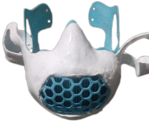
Figura 48. Desmolde de la mascarilla P80
