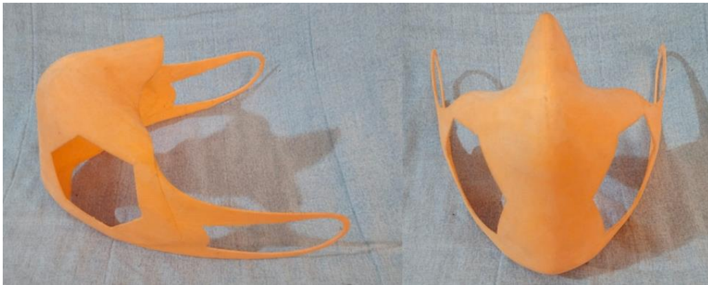
Figura 40. Molde P80 pulido y resanado
