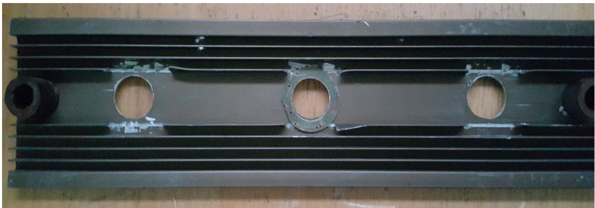
Figura 9. Disipador para el puente rectificador
