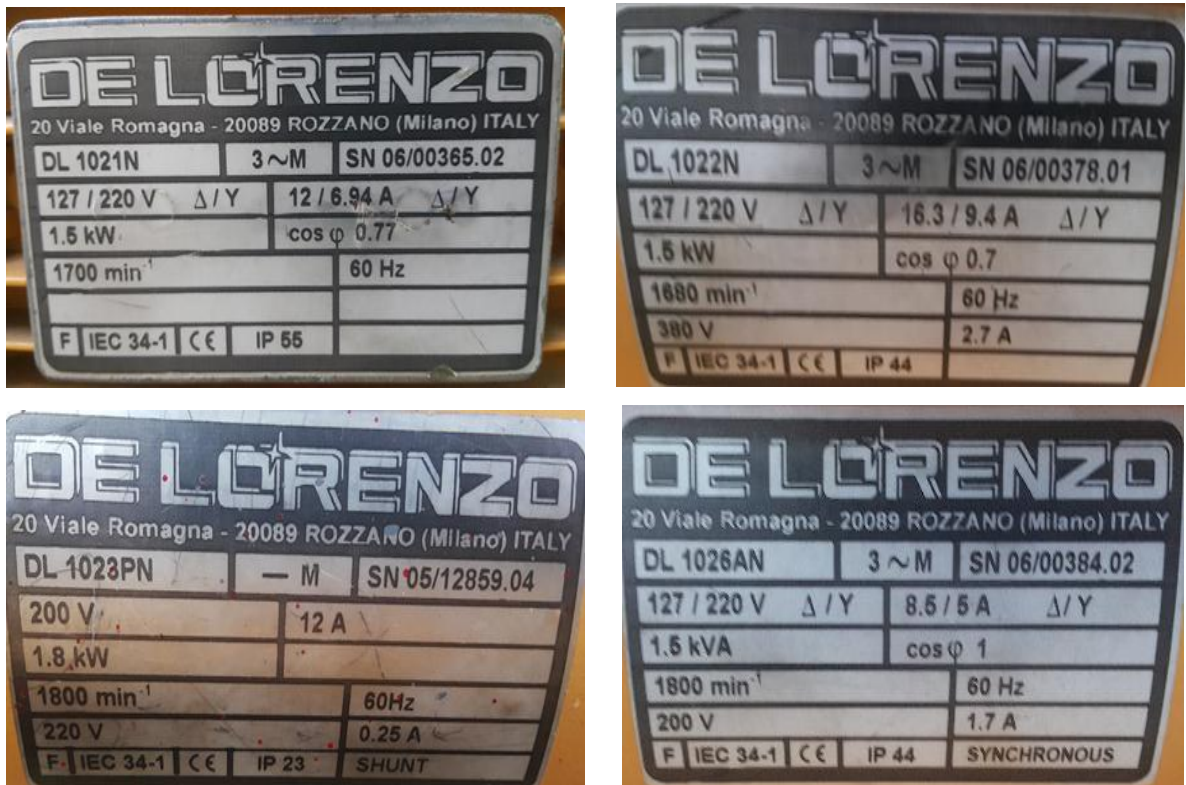
Figura 5. Placas de motores ubicados en las mesas de trabajo.
