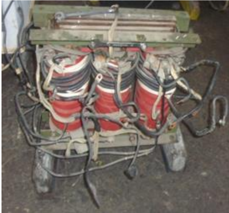
Figura 2. Estado inicial del transformador
