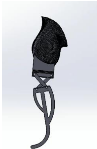
Figura 36. Alternativa 3, prototipo de prótesis en impresión 3D, rodilla no grashof
