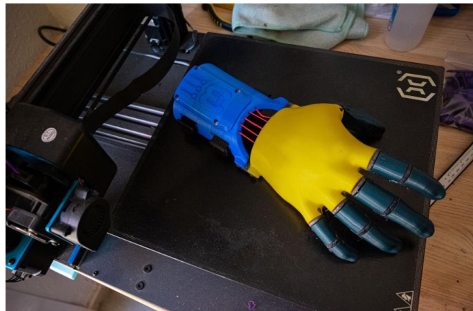
Figura 9. Impresión 3D de mano derecha
