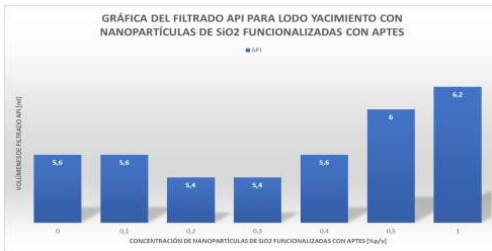
Figura 23. Gráfica de filtrado API para lodo yacimiento con nanopartículas de SiO 2 funcionalizadas con APTES
