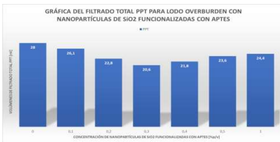
Figura 19. Gráfica de filtrado total PPT para lodo overburden con nanopartículas de SiO 2 funcionalizadas con APTES
