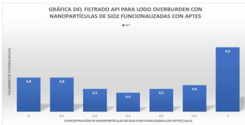
Figura 17. Gráfica de filtrado API para lodo overburden con nanopartículas de SiO 2 funcionalizadas con APTES
