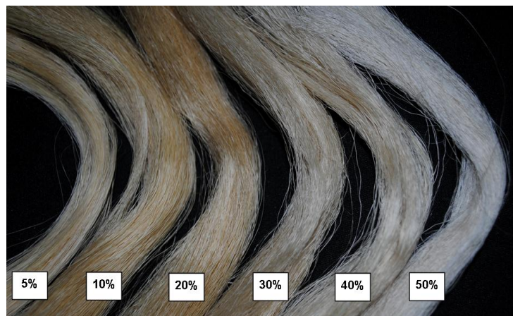
Figura 48. Fibras de Fique obtenidas tras el tratamiento con diferentes concentraciones de NaOH (5-50%).
