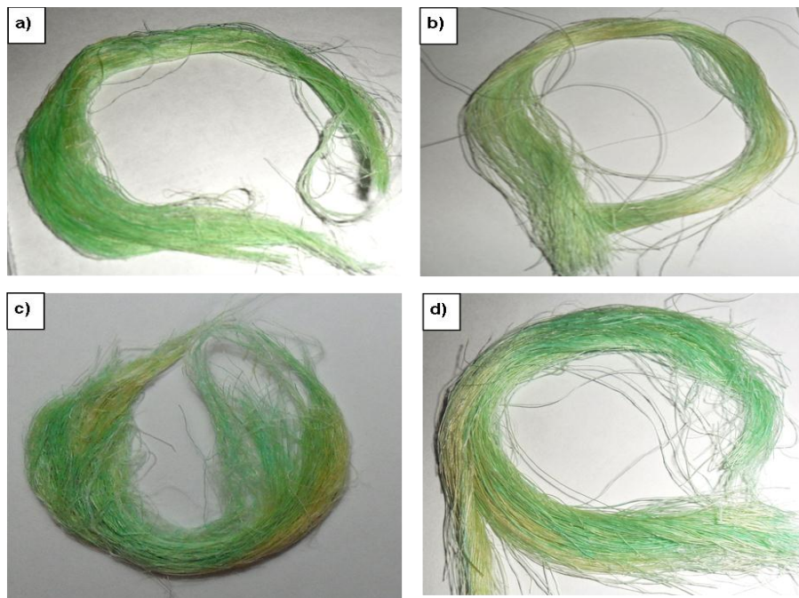
Figura 71. Biocompuestos de MOF-199 obtenidos tras la síntesis in situ sobre fibras de Fique sometidas a tratamiento alcalino-ácido: a) y b) Biocompuestos obtenidos por el método de agitación mecánica. c) y d) Biocompuestos de MOF-199 obtenidos por el método de ultrasonido
