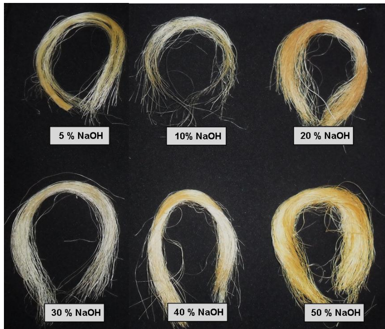
Figura 70. Fibras de Fique obtenidas tras el proceso de carboximetilación. Se señala para cada conjunto de fibras la concentración de NaOH empleada durante la etapa de basificación del proceso de carboximetilación.
