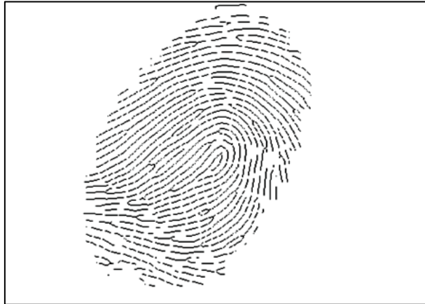
Figura No 15: Impresión Dactilar luego de aplicar el proceso de esqueletización Fuente: Imagen obtenida utilizando el módulo de procesamiento desarrollado
