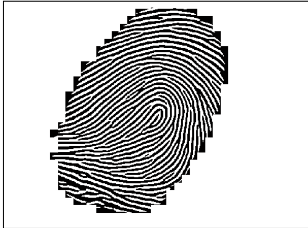
Figura No 14: Imagen luego de ser filtrada y binarizada Fuente: Imagen obtenida utilizando el módulo de procesamiento desarrollado
