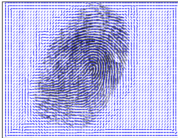
Figura No 12: Campo de orientación de Una Huella Dactilar Fuente: Imagen obtenida utilizando el módulo de procesamiento desarrollado
