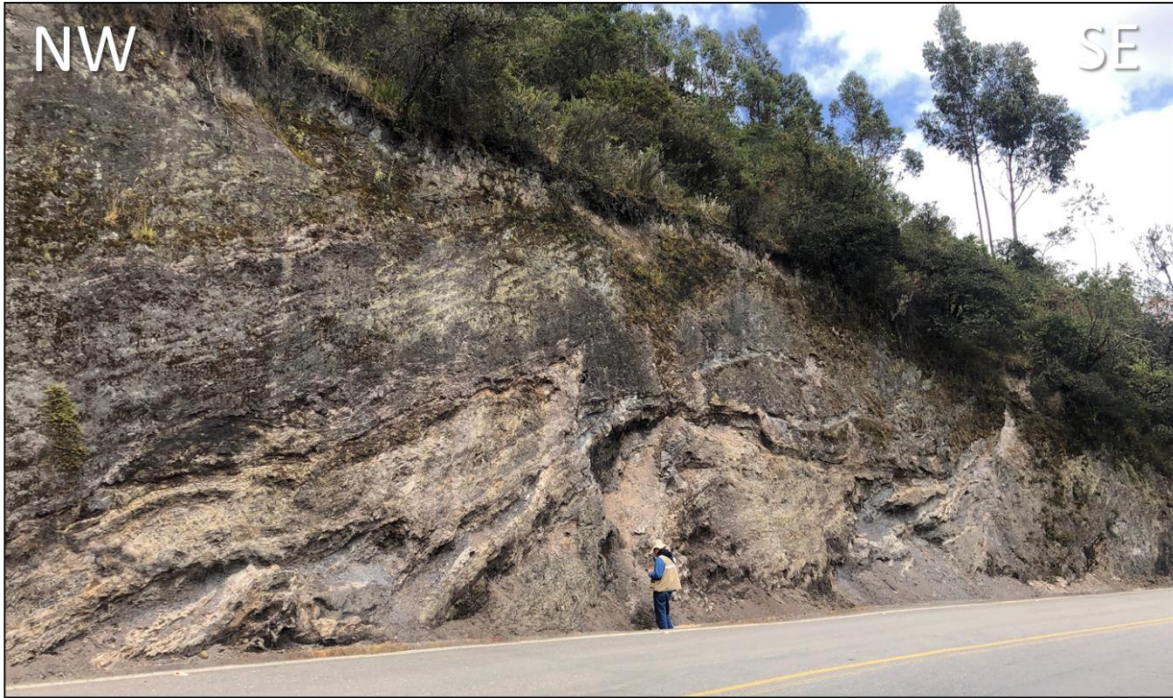
Fig. 13. Formación Capacho, vía Belén- Susacón, margen izquierdo; potentes lodolitas fósiles gris oscuro y en menor proporción delgadas capas de areniscas. Coordenada: E 1135042, N 1167163, h 3246 m.s.n.m. Datum MAGNA SIRGAS.
