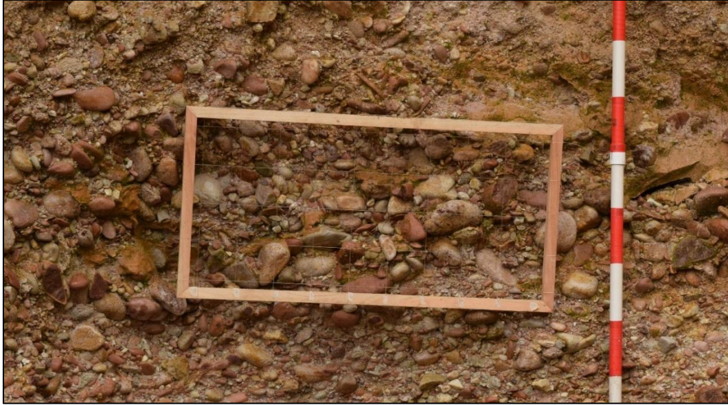
Fig. 4. Malla de 50 puntos, utilizada para la metodología de conteo de clastos.
