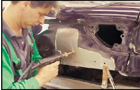
Figura 44. Conformado de deformaciones con electrodo de carbono.
