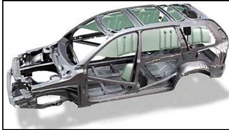
Figura 13. Cuerpos huecos en los elementos estructurales de una carrocería.
