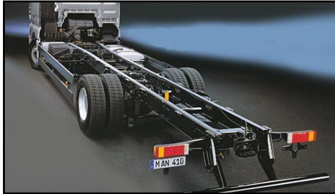
Figura 2. Bastidor de vehículo de carga.
