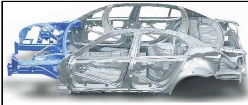
Figura 4. Carrocería autoportante (desprovista de elementos móviles).
