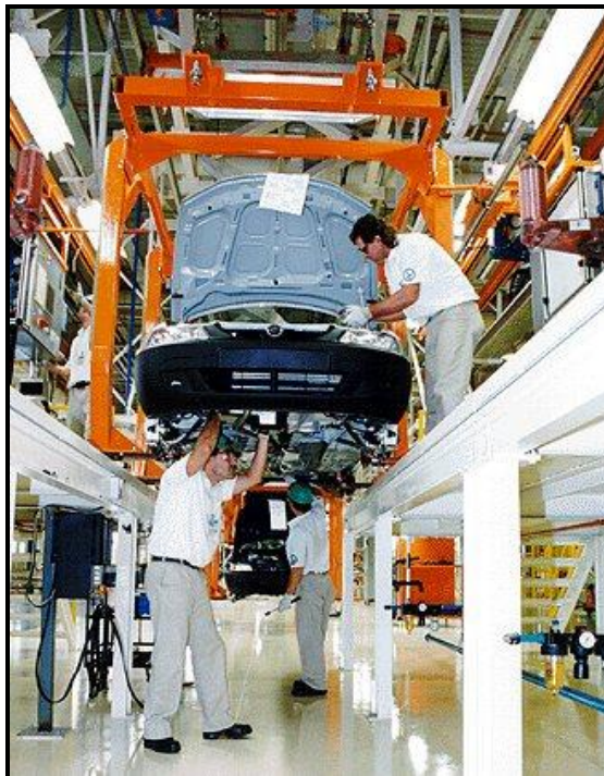
Figura 8. Ensamble del motor
