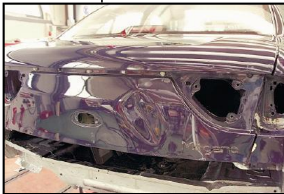
Figura 35. Hundimiento en el capó trasero.
