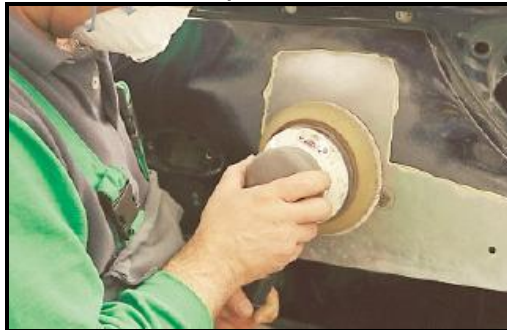
Figura 45. Eliminación de marcas superficiales mediante abrasivos.
