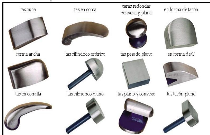
Figura 32. Diferentes tipos de tases.
