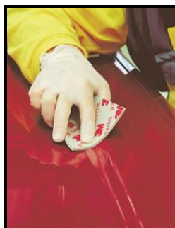
Figura 29. Detección de deformaciones mediante el lijado de la zona
