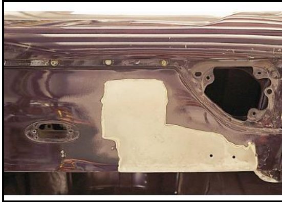
Figura 46. Lijado de la superficie trabajada.
