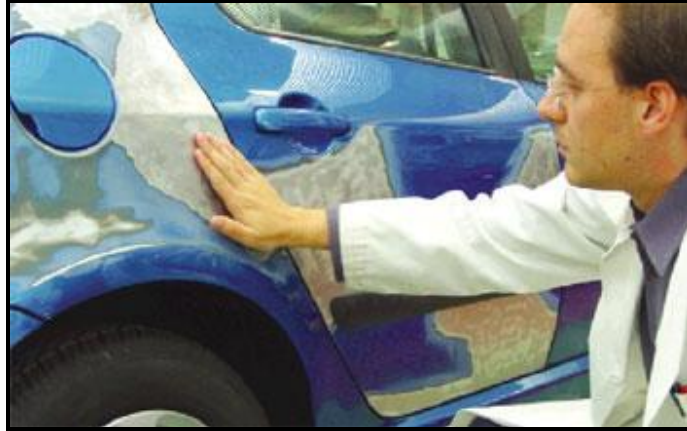
Figura 30. Detección de deformaciones con la palma de la mano
