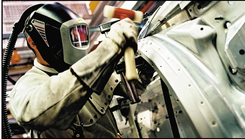
Figura 106. Protección en aplicación de soldadura.
