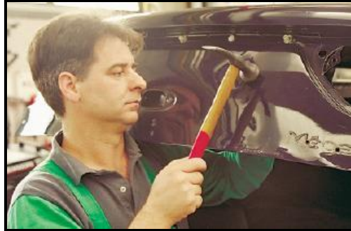
Figura 36. Tratamiento mecánico con tas y martillo.
