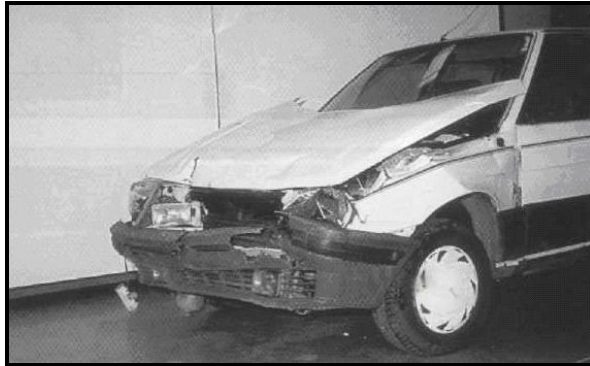
Figura 70. Golpe delantero de un Renault 12.
