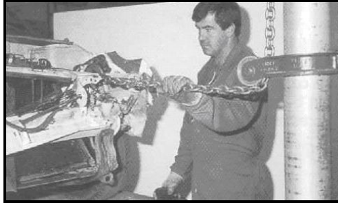
Figura 76. Tirón inicial a la travesía superior.
