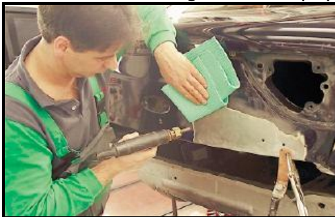
Figura 43. Rápido enfriamiento con una gamuza empapada en agua.
