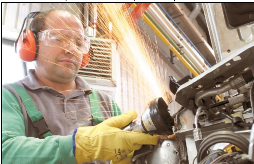
Figura 103. Protección personal del chapista en operaciones de corte.
