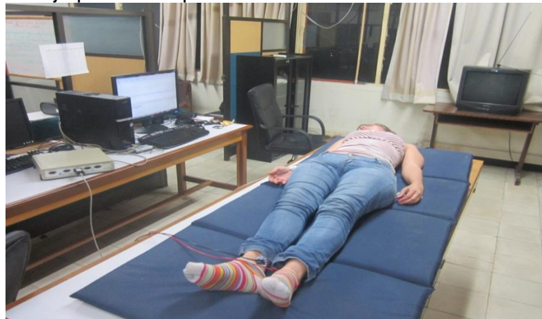
Figura 20. Montaje para la adquisición de la señal de ECG
