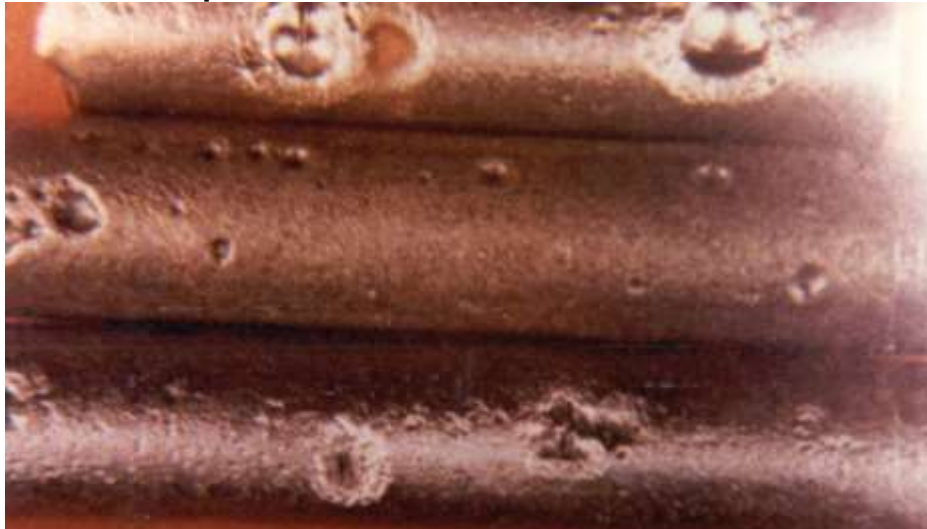
Figura 21. Corrosión por H 2 S.
