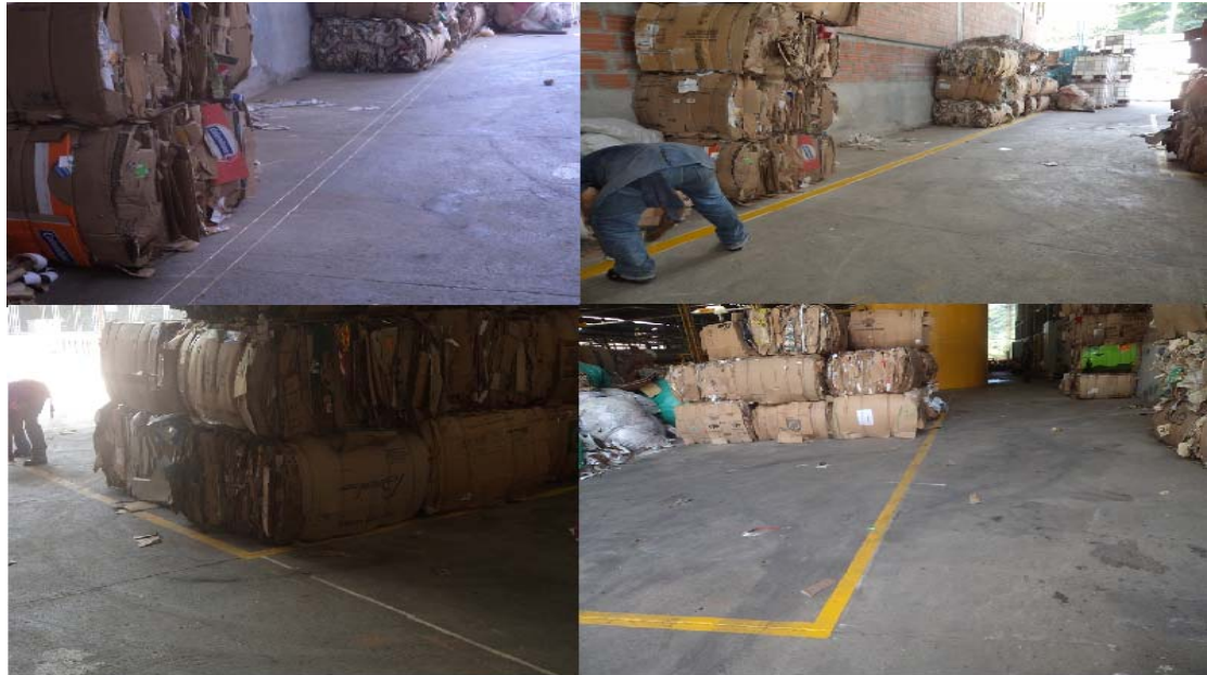
Figura 29. Fotos de demarcado de zonas de almacenamiento
