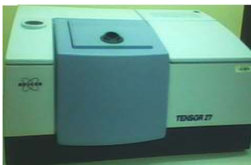
Figura 6. Espectrofotómetro FT-IR Bruker Tensor 27
