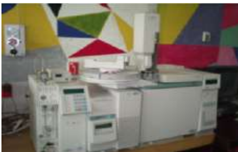
Figura 7. Equipo CG-EM marca Agilent Technology 6890 series GC System
