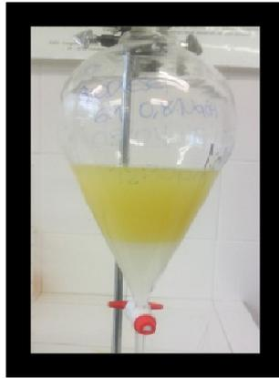
Figura 8. Lavado del Biodiesel
