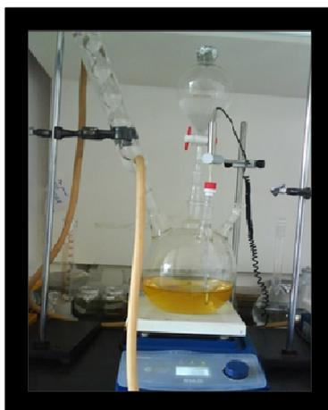
El aceite (ASM-Palma) fue precalentado en un horno a 110°C durante una hora antes de ser depositado en el balón aforado, esto con el fin de eliminar el agua que posiblemente pueda contener.
