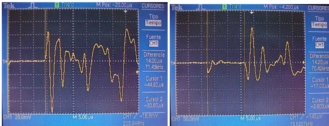
Figura 55. Ondas P generadas. A la izquierda señal obtenida a partir del equipo antiguo. A la derecha, señal producida por el nuevo generador.
