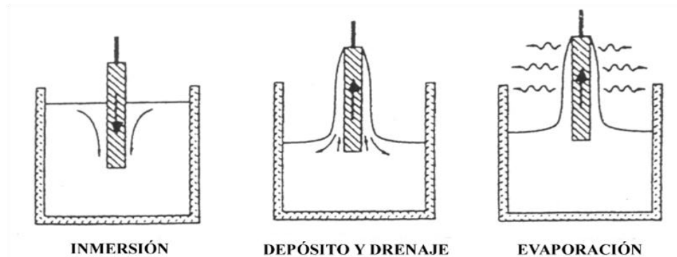
Figura 4. Etapas del proceso Dip-coating.
