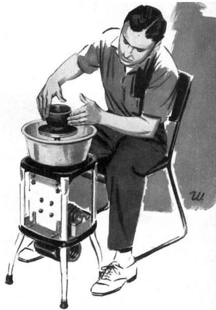
Figura 11. Torno alfarero hecho en un banquillo de cocina. Por Ross E. Williams. Revista Mecánica Popular - Volumen 9 - Diciembre de 1956 - Número 6. Tomado de: http://www.mimecanicapopular.com/verherr.php?n=36
