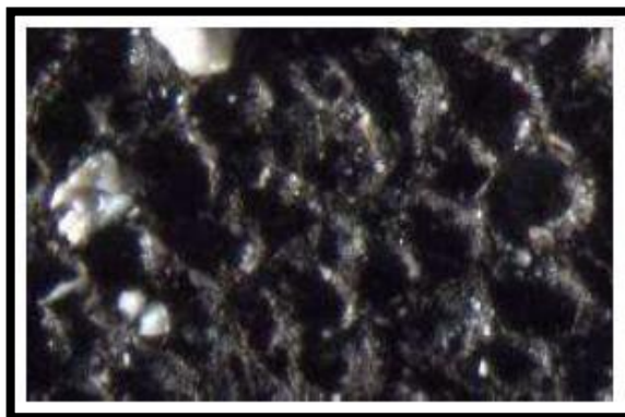
Figura 73. Empotramiento del propante
