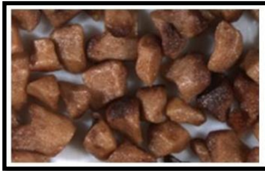
Figura 62. Estructura porosa de Cascarones de nuez con Recubrimiento.
