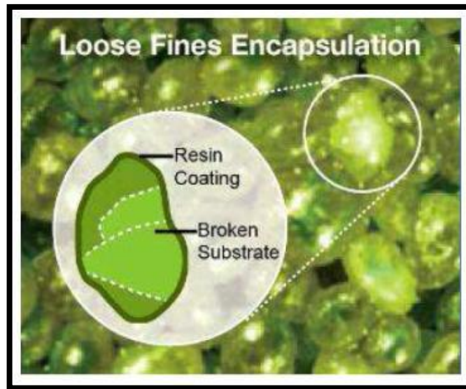
Figura 78. Encapsulamiento de cada grano en resina.
