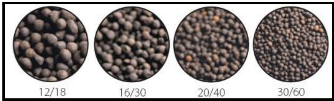
Figura 63. Tamaños de la Bauxita Sinterizada
