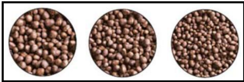
Figura 50. Arenas Recubiertas con Resinas.
