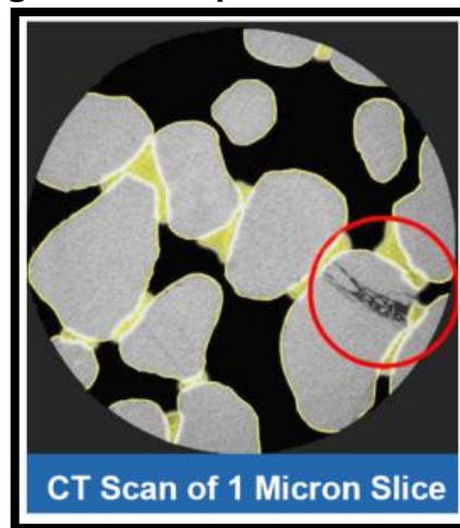
Figura 79. CT. Tecnología utilizada para verificar el encapsulamiento.
