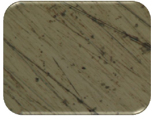
Figura B.5 Bracket y Probeta, Electropulido + Sin Pasivación: k) 10X y l) 50X
