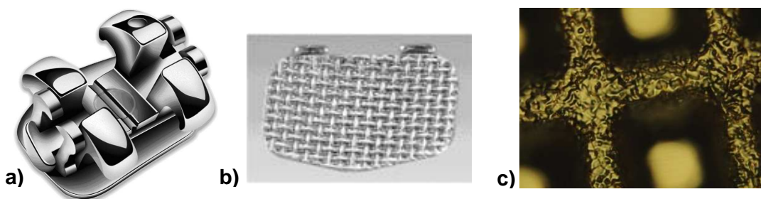
Figura 1. Bracket SmartClip ; Compañía: Lancer Praxis Glide 2006. a) Cuerpo; b) Base y c) Límites de grano con Carburos de Cromo en la base
