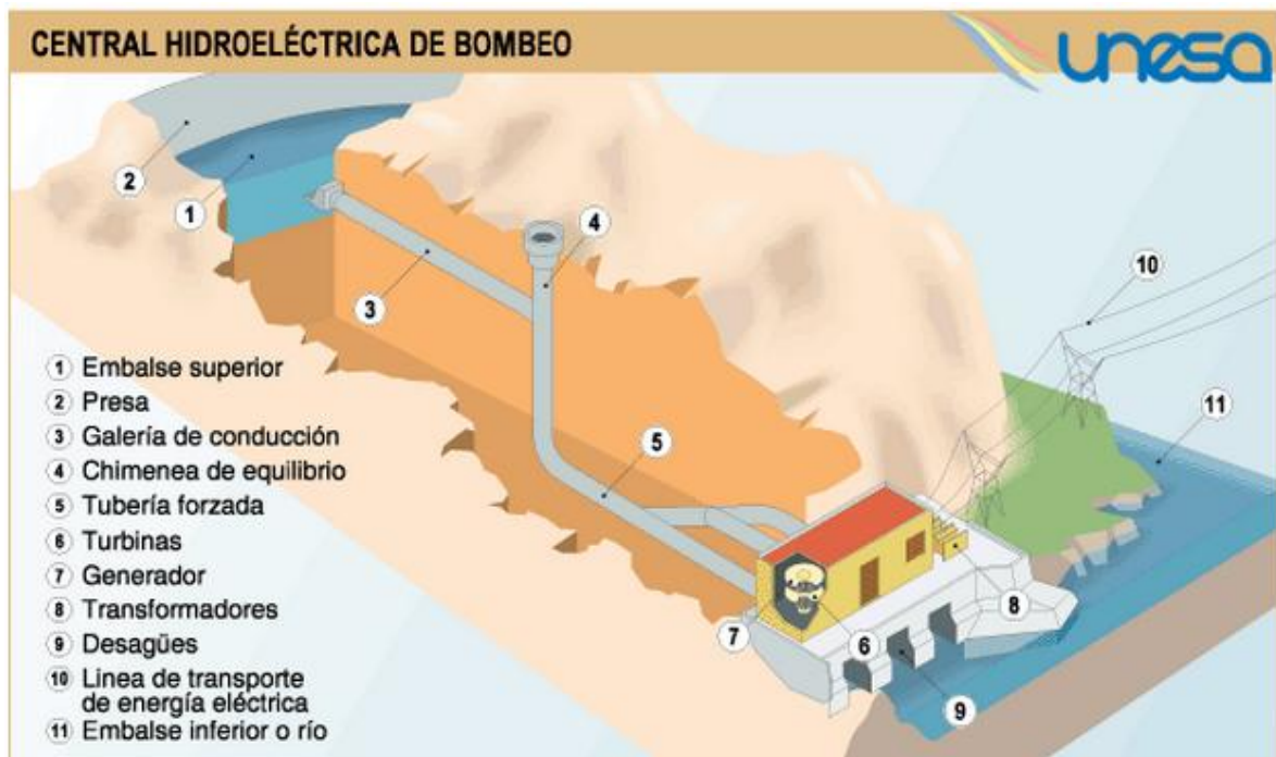
Figura 173 Funcionamiento de una central de bombeo puro
