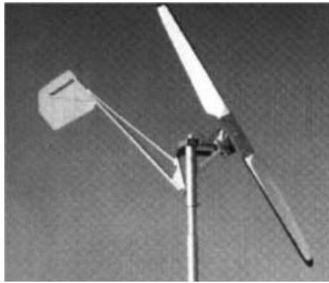
Figura 158 Sistema orientado por veleta
