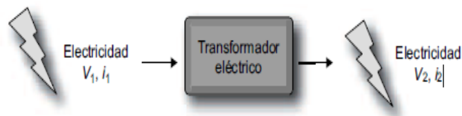
Figura 72 Esquema conceptual de un transformador eléctrico
