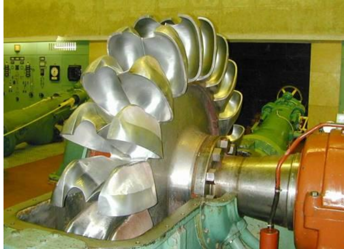
Figura 180 Turbina Pelton de eje horizontal
