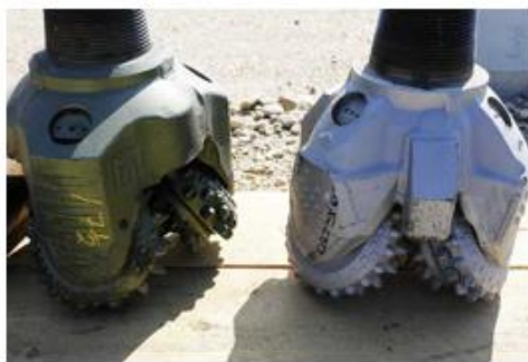
Figura 37. Brocas de perforación
