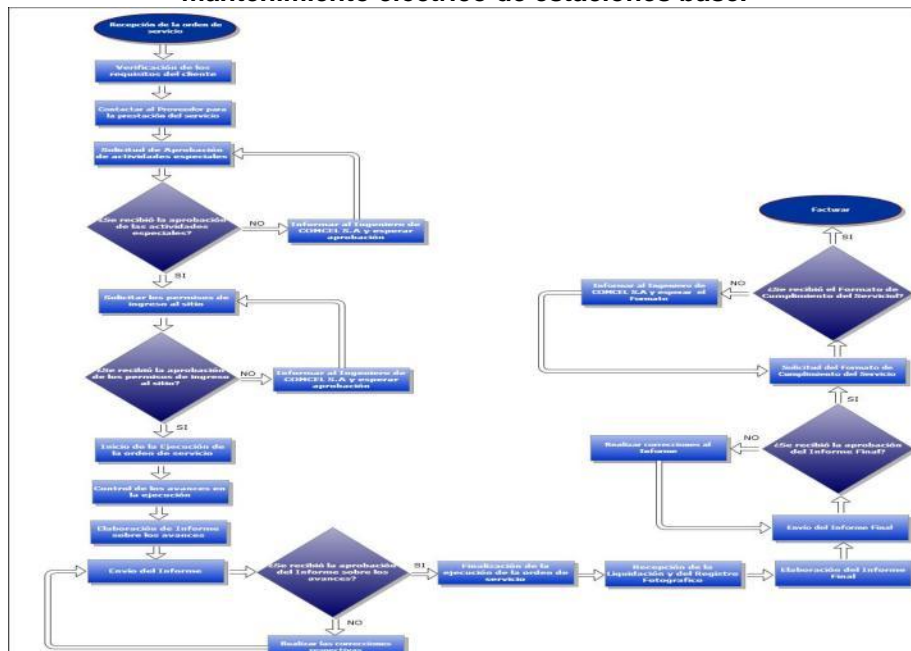
Figura 9 Diagrama de flujo para la ejecución de órdenes de servicio en el proyecto mantenimiento eléctrico de estaciones base.
