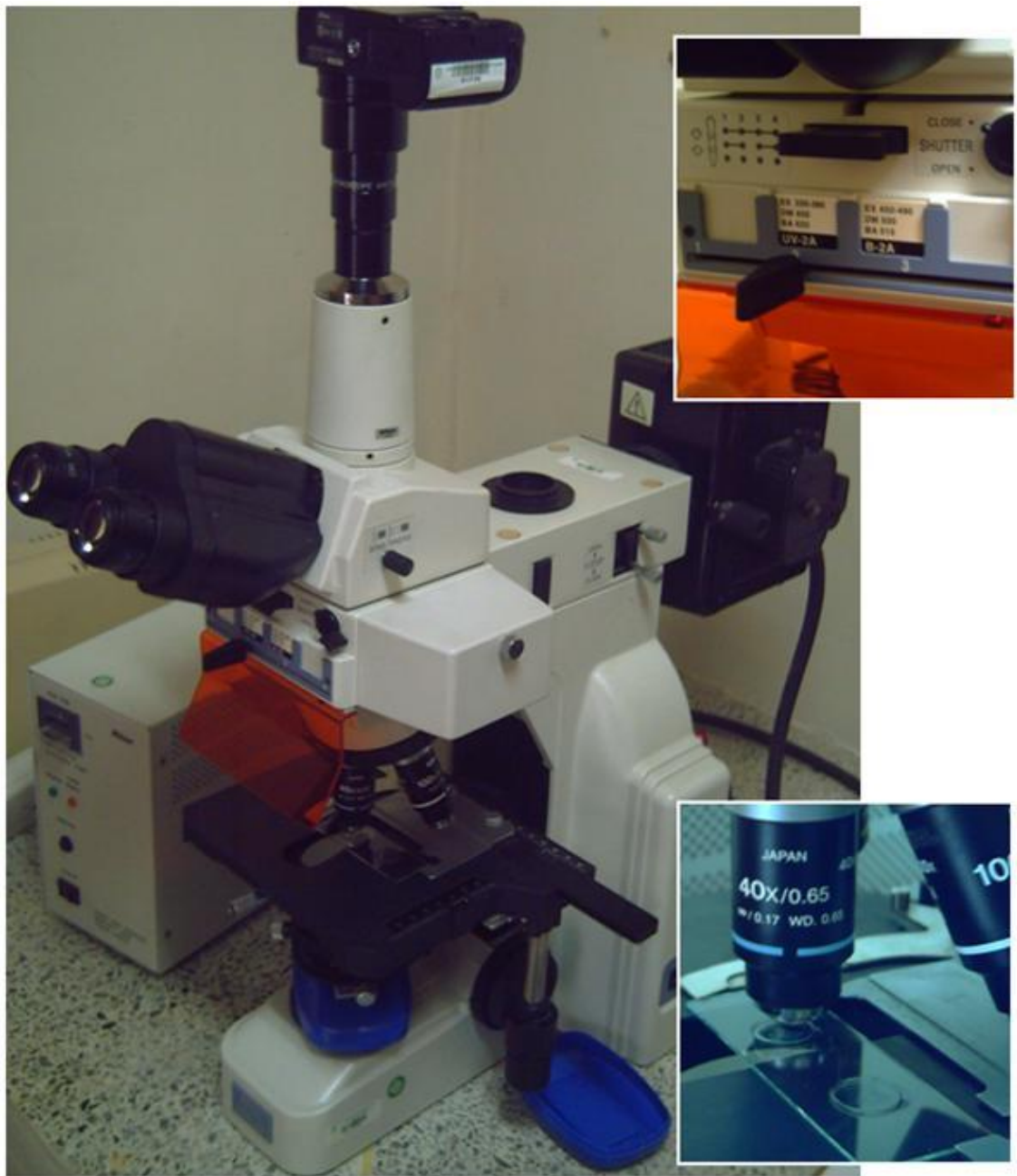
Figura 17. Montaje realizado para la adquisición de las imágenes fluorescentes trabajadas.
