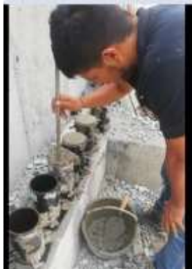
Figura 17. Probetas para ensayos de compresión del concreto.
