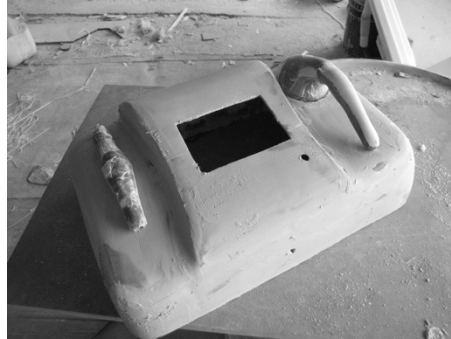
Figura 151. Recubrimiento con hueso duro y masilla.
