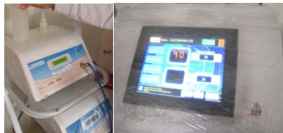
Figura 2. Protección de carcasas con vinipel
