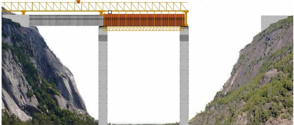
Figura 71. Encofrado de la cimbra autoportante.
