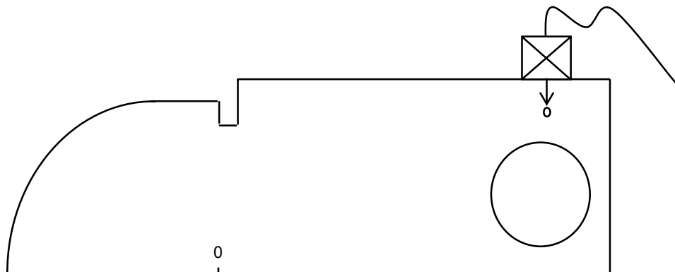
Figura 13. Palpador sobre el bloque IIW justo en el barreno de 0.060”
