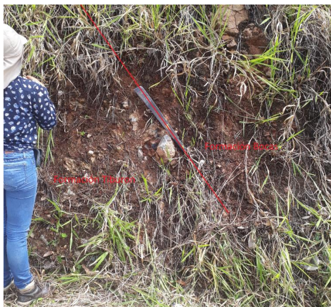
Figura 21. Afloramiento del contacto geológico entre la Formación Bocas y la Formación Tiburón.
