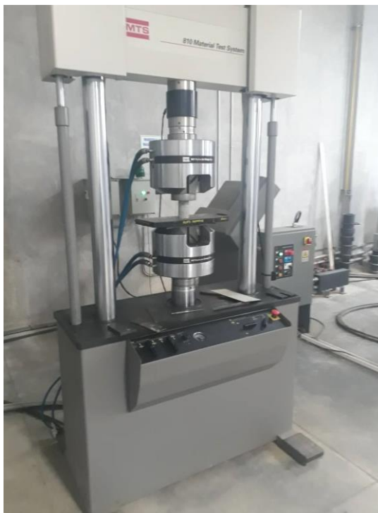
Figura 2. Prensa utilizada para el análisis de presión simple, ubicada en el laboratorio de ingeniería civil de la UIS.
