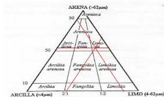
Figura 29. Triángulo de clasificación textural con las líneas de porcentaje de los tamaños de grano para nombrar la roca sedimentaria según Folk 1962.
