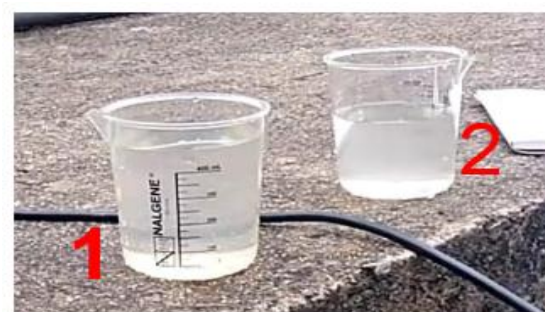
Figura 98. Muestras de agua floculada.
