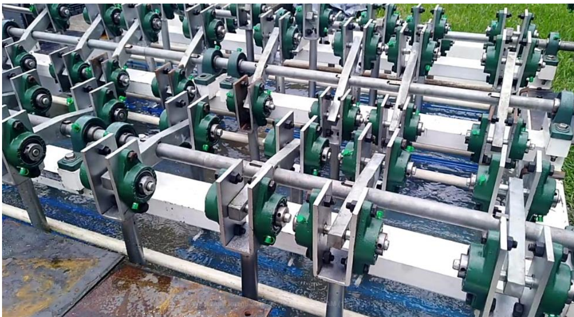
Figura 99. Sistema de agitación del prototipo en funcionamiento.
