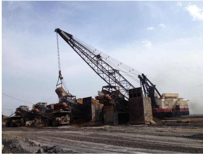
Figura 14. Método de Cargue Dragalina – Apron Feeder - Camión.
