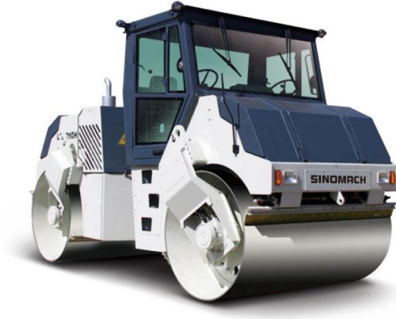
Figura 5. Rodillo Compactador vibratorio de doble tambor
