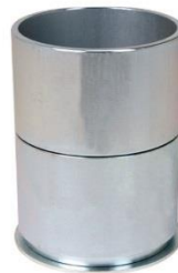
Figura 4. Dispositivo para moldear probetas Marshall.
