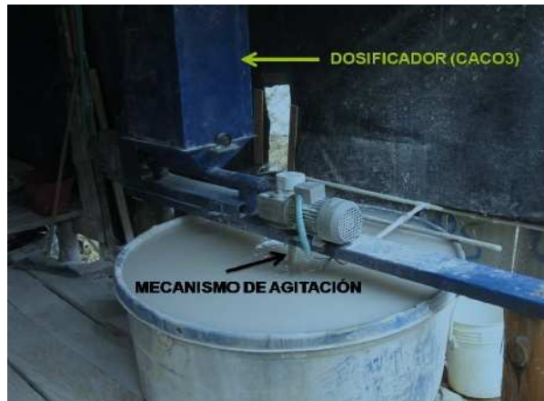
Fotografía 5. Tratamiento Activo usando dosificación con temporizador utilizando agitación mecánica.
