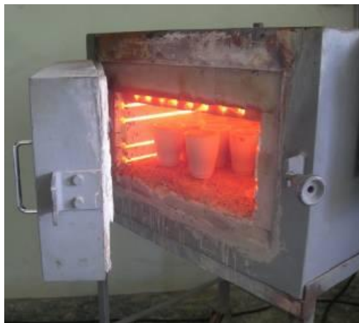
Figura 3. Crisoles en fundición.
