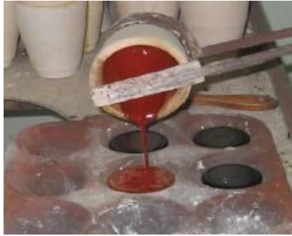
Figura 4. Vaciado del material fundido a las palloneras.
