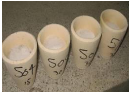
Figura 2. Crisoles con cargas listas para ingresar a fundición.
