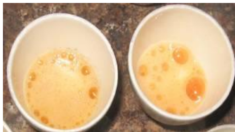
Figura 8. Reacción entre la plata presente en el doré y el ácido nítrico.
