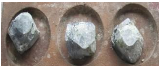
Figura 6. Regulus listos para ingresar al horno de copelación.
