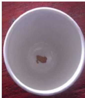
Figura 9. Oro obtenido después de la eliminación de la plata.
