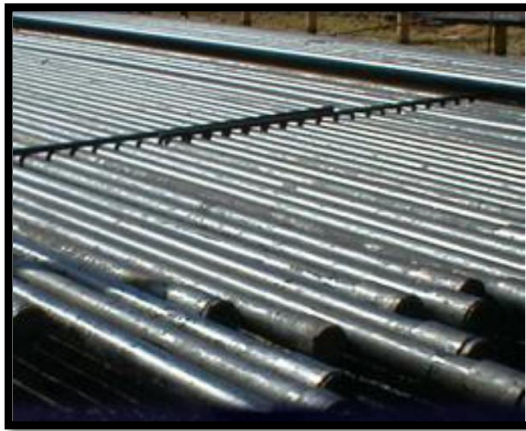
Figura 44: Tubería de Producción.
