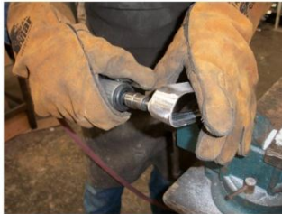
Pulido detalles internos con mototool
