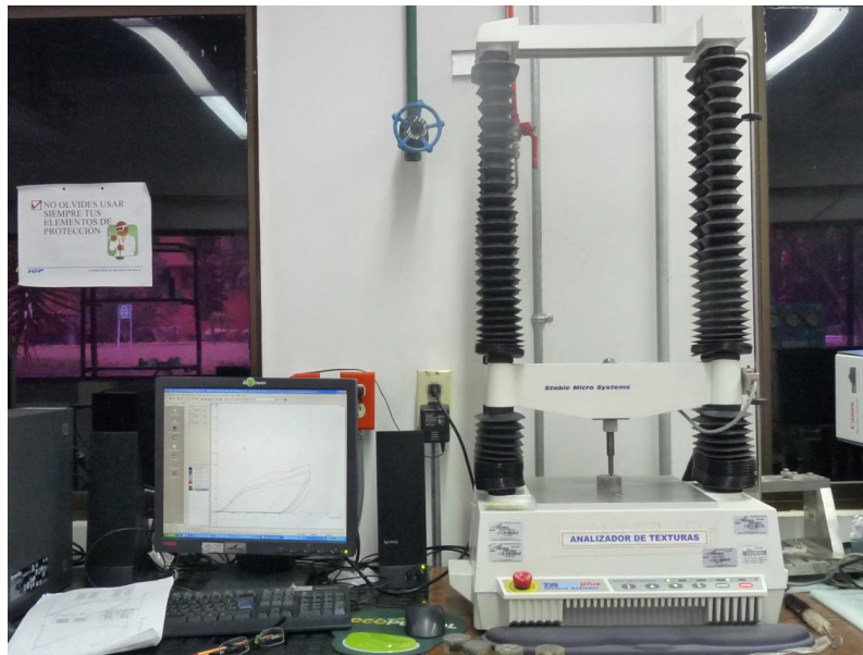
Figura 11. Esquema del montaje para la ejecución de la prueba de indentación
