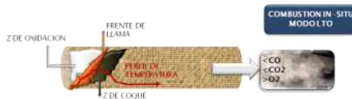
Figura 7. Prueba de Tubo en modo LTO
