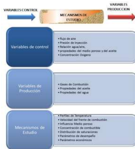
Figura 6. Tipos de variables en pruebas de tubo
