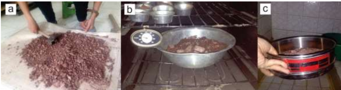
Figura 9. Proceso de preparación de muestra para el conteo de guijos a. cuarteo b. lavado-secado y c. tamizado.
