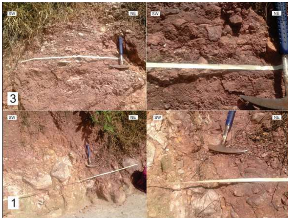
Figura 8. Método de la cinta (Howard, 1993) realizado en la sección de la La Punta, Mesa de Los Santos.
