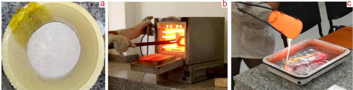
Figura 3. Fritas de las composiciones de la tabla 1. a) F1, b) F2 y c) F3.
