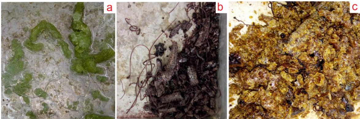
Figura 3. Fritas de las composiciones de la tabla 1. a) F1, b) F2 y c) F3.
