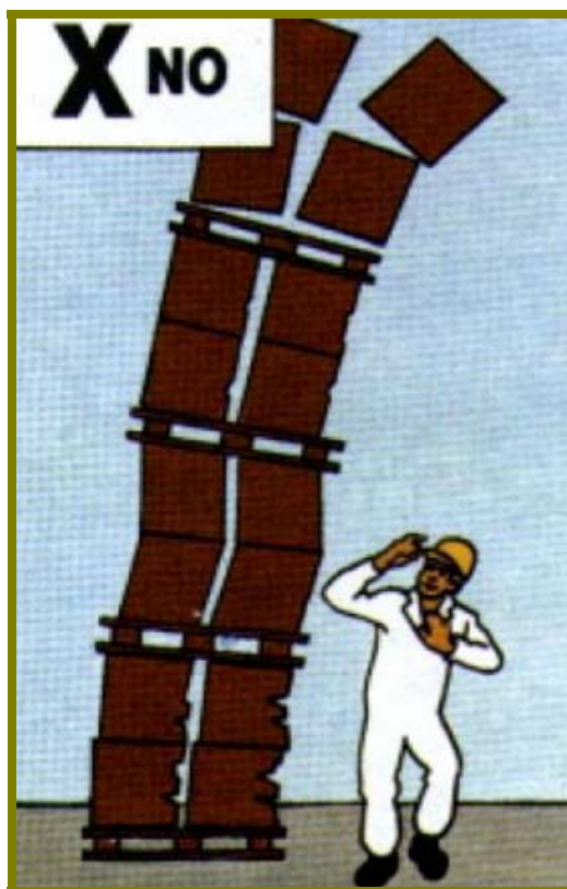
Figura 29. Apilamiento. El apilamiento nunca debe exceder la altura recomendada
