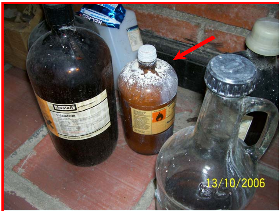
Foto 8. (Autores) Almacenamiento incorrecto de residuos peligrosos
