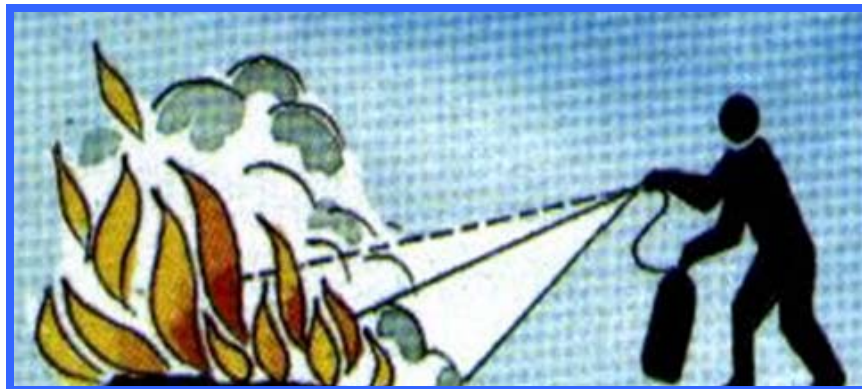
Figura 37. Polvo Químico: A partir de la base del fuego mover hacia arriba del fuego.
