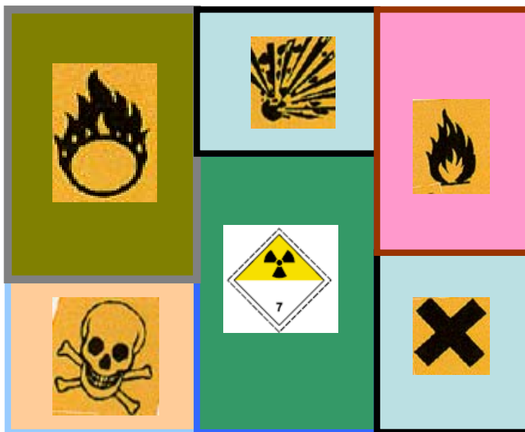
Figura 30. Separación de sustancias peligrosas. No se deben mezclar sustancias peligrosas que sean incompatibles
