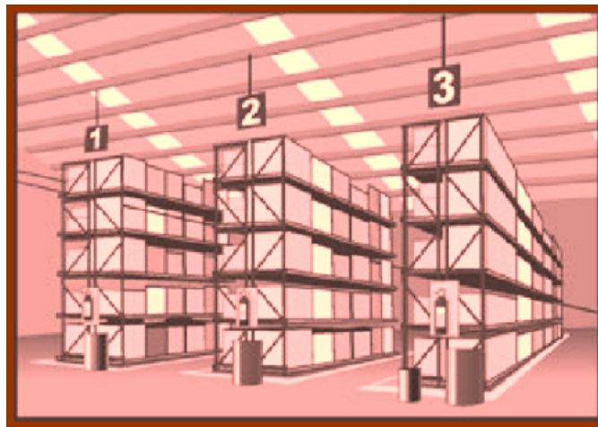
Figura 28. Planificación del almacenamiento. Los pasillos deben ser suficientemente amplios para el tráfico. El sistema de estantería debe evitar la caída de sustancias y asegurar su estabilidad
