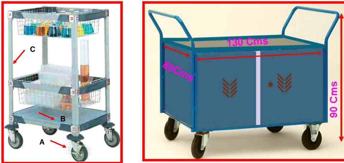
Figura 8. Ejemplo de un carro manual para el transporte interno de residuos. En él se pueden apreciar las siguientes características de diseño (A) ruedas con balineras que permiten fácil desplazamiento soportando gran cantidad de peso, (B) Bandejas recubiertas con polímeros que no son degradados por los químicos, (C) Columnas de soporte que le dan gran estabilidad a toda la estructura.
