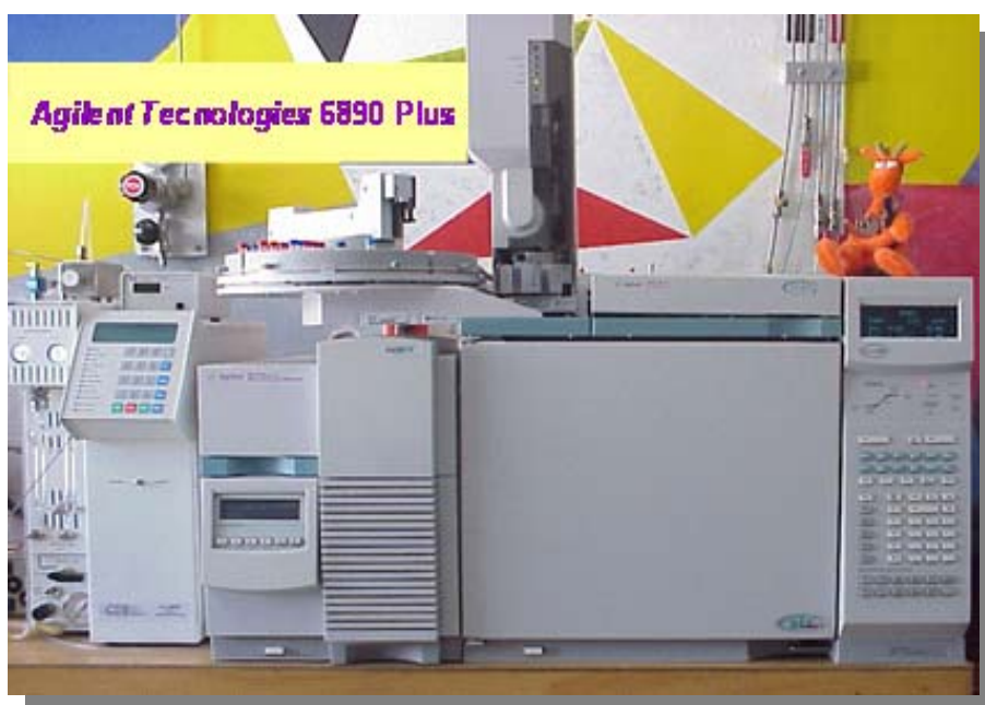
Figura 29. Cromatógrafo de gases Agilent Technologies 6890 Plus , con un inyector automático Agilent 7863 , un sistema de datos HP-MS ChemStation (Versión 1.05), acoplado a un detector selectivo de masas Agilent Technologies MSD 5973 .
