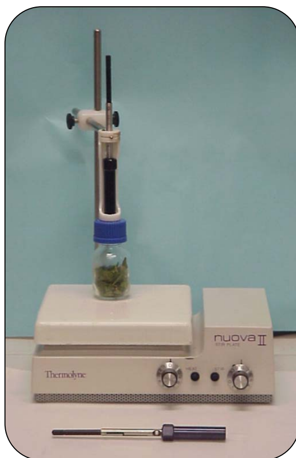
Figura 28. Montaje utilizado para la extracción por HS-SPME.
