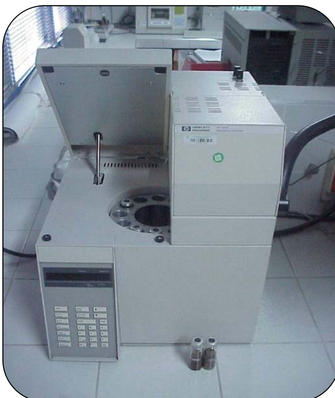
Figura 27. Equipo Headspace Sampler HP 7694 ( Hewlett-Packard , Palo Alto, CA, EE.UU.), empleado para la técnica headspace estático.
