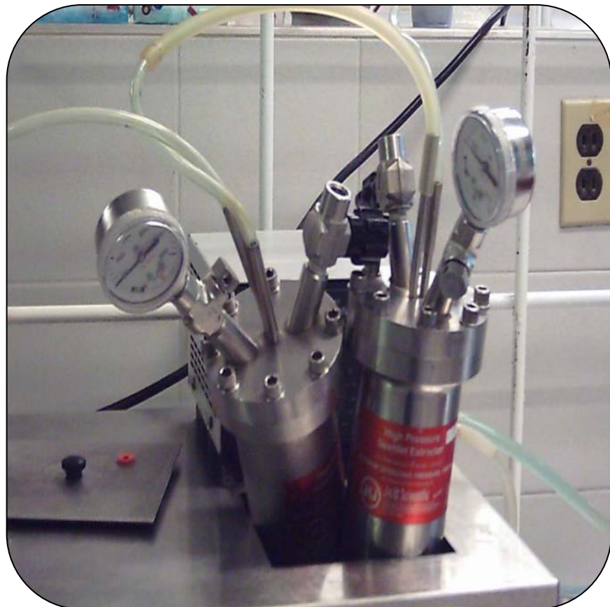
Figura 26. Extractor Soxhlet de alta presión, para la obtención de extractos vegetales con fluido supercrítico SFE (CO 2 ).
