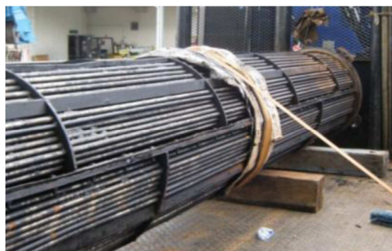
Figura 16. Tubos del Intercambiador H1302 de Lado Cabezal.
