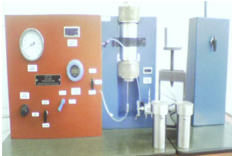
Figura 22. Porosímetro de Helio, COREPET.
