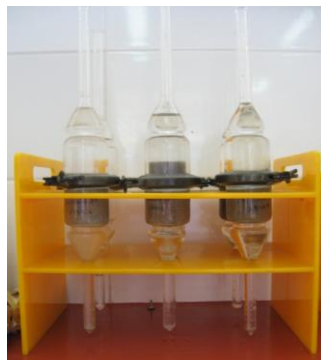
Figura 27. Equipo para la determinación de la mojabilidad cualitativamente, método de Amott-Harvey.
