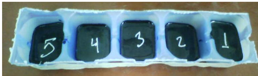
Figura 74. Muestras saturadas con la resina epóxica dentro de la cubeta.
