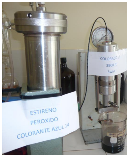
Figura 64. Desplazamiento de monómero estireno con peróxido de benzoilo y colorante azul 14.
