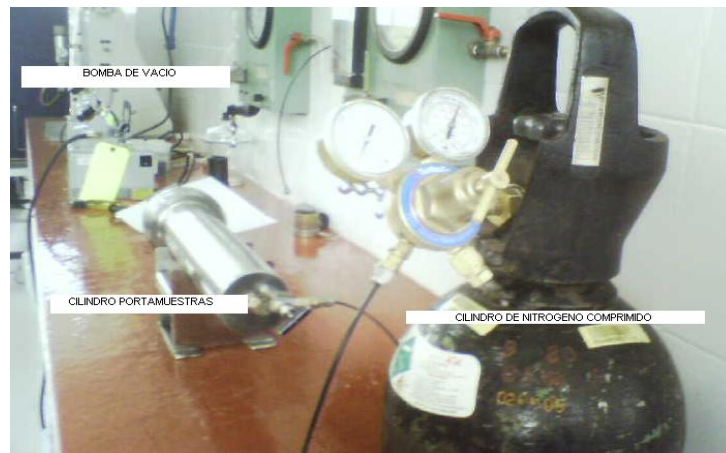
Figura 72. Equipo para saturar las muestras con la resina epóxica.
