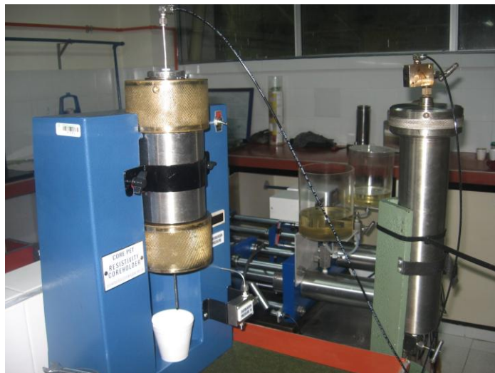
Figura 38. Equipo de desplazamiento (Core Holder).
