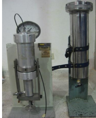
Figura 28. Core Holder, equipo de desplazamiento forzado.
