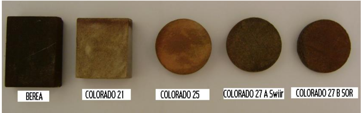
Figura 65. Muestras saturadas y solidificadas cien por ciento de monómero estíreno con su iniciador (peróxido de benzoilo) y colorante azul 14.
